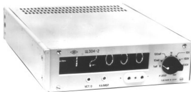
Предназначен для измерения постоянного напряжения от 0,1 мкВ до 500В в цеховых и лабораторных условиях, а также для работы в измерительных системах. Вольтметр Щ304-2 - многопредельный. Поддиапазоны измерения устанавливаются переключателем вручную. Полярность измеряемого напряжения определяется автоматически. Быстродействие: 25 преобразований в секунду. Вольтметр имеет автоматический и внешний запуски.
